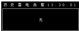
图 7：操作 UP/DN 键，切至最新告警页面或状态页面
