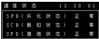
图 5：操作 OK 键，则显示遥信状态数据、温湿度页面
